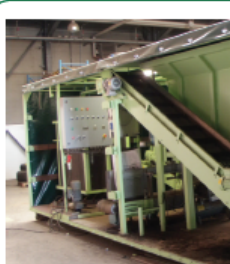
De opzackmachine zorgt ervoor dat we vanaf nu producten (zoals onze compost, potgrond, maar ook bodembedelker, zout en zand...) gemakkelijk zelf en op grotere schaal in zakken kunnen aanbieden.
